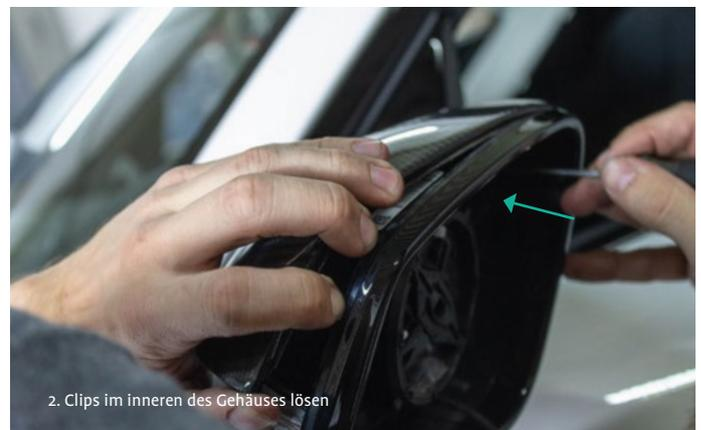
2. Clips im inneren des Gehäuses lösen
