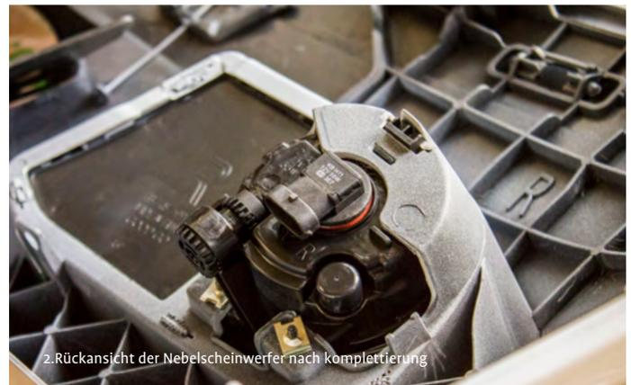
2. Rückansicht der Nebelscheinwerfer nach kompletierung
