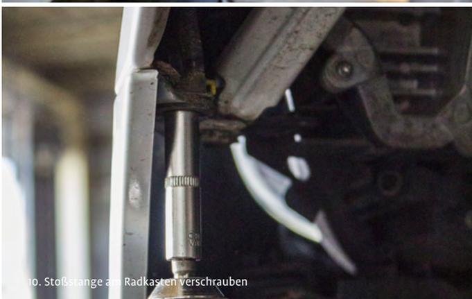
10. Stoßstange am Radkasten verschrauben
