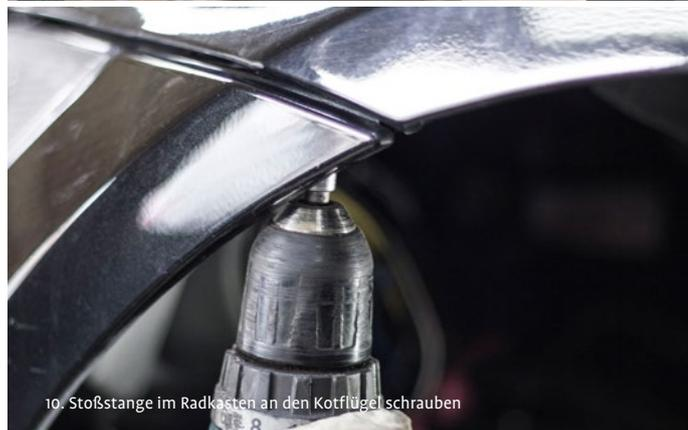
10. Stoßstange im Radkasten an den Kotflügel schrauben
