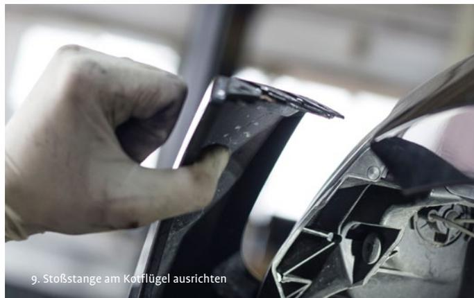
9. Stoßstange am Kotflügel ausrichten
