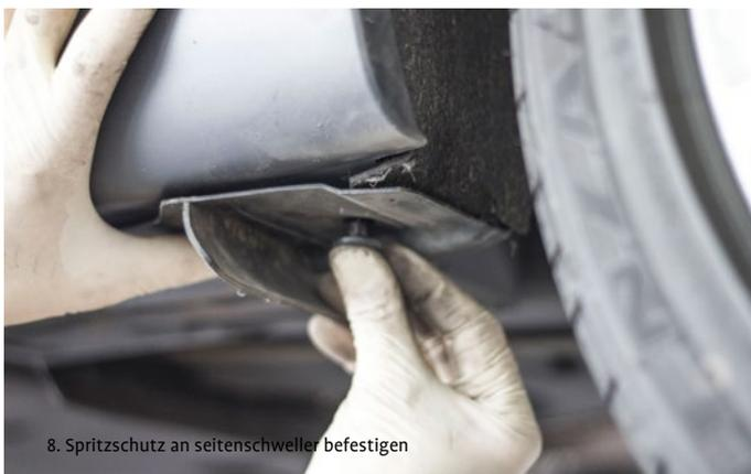
8. Spritzschutz an seitenschweller befestigen
