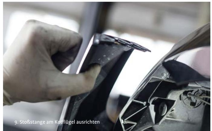
9. Stoßstange am Kotflügel ausrichten
