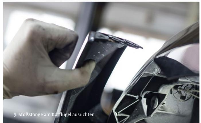
9. Stoßstange am Kotflügel ausrichten
