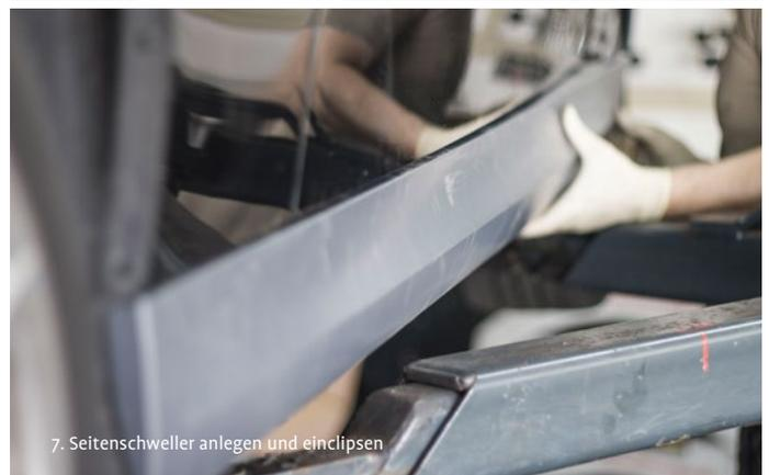
7. Seitenschweller anlegen und einclipsen
