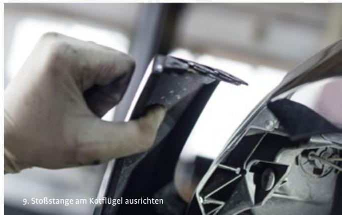
9. Stoßstange am Kotflügel ausrichten
