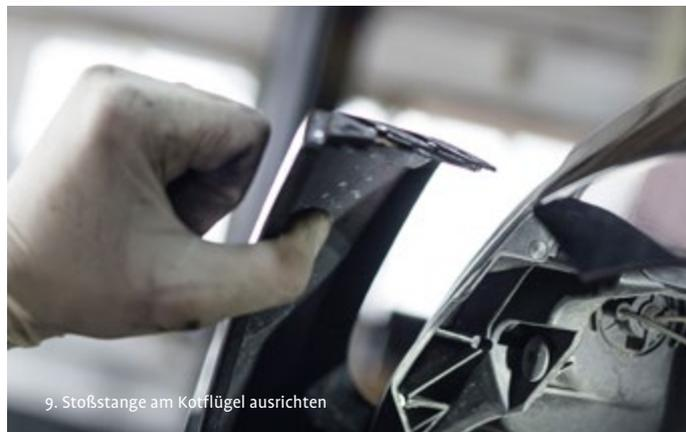
9. Stoßstange am Kotflügel ausrichten
