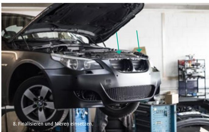
8. Finalisieren und Nieren einsetzen.
