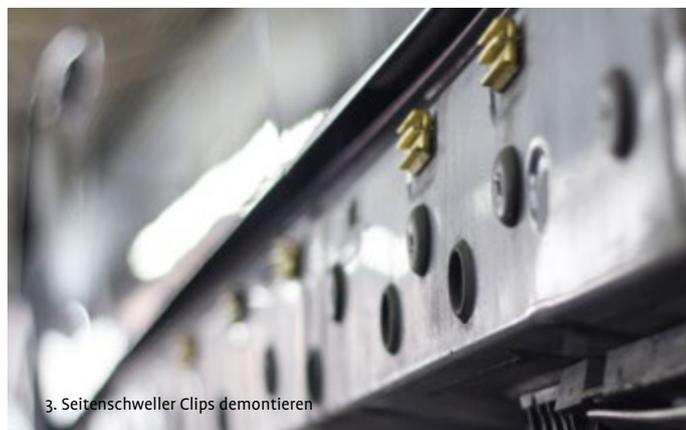
3. Seitenschweller Clips demontieren
