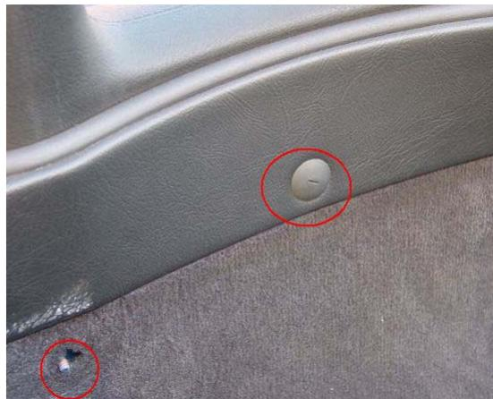
Die kleine Blende mit einem Kreuzschlitz, bzw. Torx T9 Schraubendreher entfernen.
