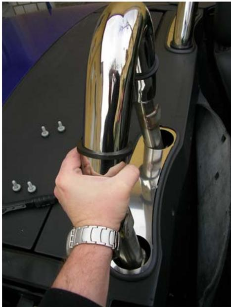
Befestigung der Bügel durch die vier original Schrauben.
