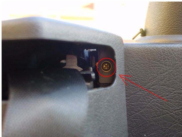
Hier befindet sich ein Schraube (8er Maulschlüssel)
