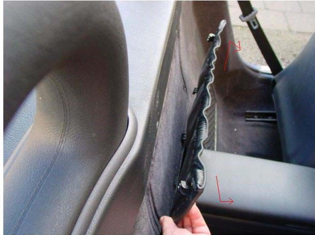
Nun die 2 oberen Druckknöpfe und die 2 Aufnahmen für das Windschott entfernen.
