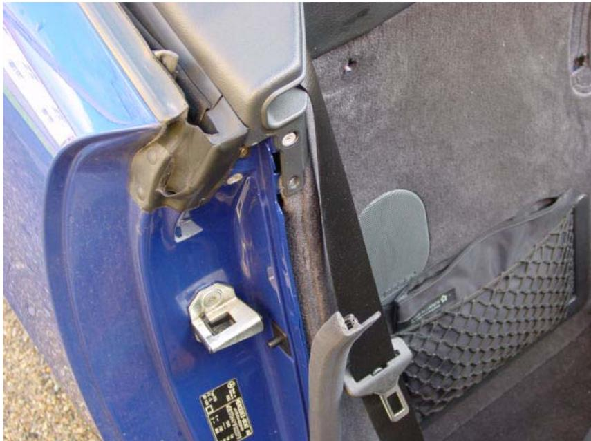
Die Gurtdurchführung muss nun ausgeclipst werden. Am einfachsten von unten nach oben drücken.
