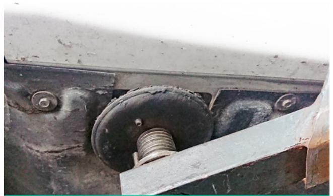
Bild 1: Schrauben unterhalb der Seitenschweller entfernen
