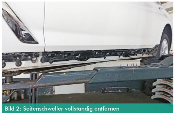
Bild 2: Seitenschweller vollständig entfernen
