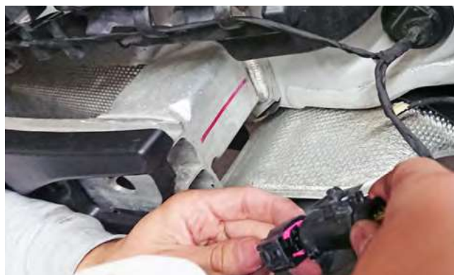
Bild 11: Vor dem Zusammenbau den Stecker anklemmen
