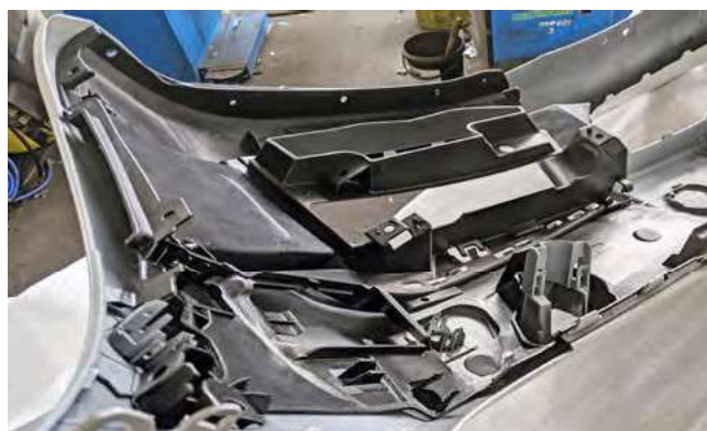
Bild 18: Aufnahmen in die neue Stoßstange einclipsen
