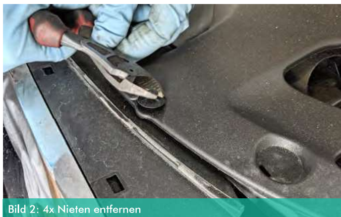
Bild 3: 4x Nieten entfernen
