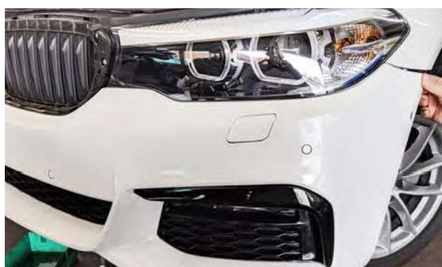
Bild 34: Stoßstange ausrichten und wieder zusammenbauen
