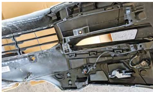
Bild 27: PDC Sensoren aus den Serienhalterungen lösen
