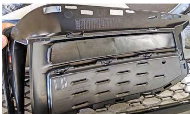
Bild 15: Stoßstangengitter + Abdeckung einrasten
