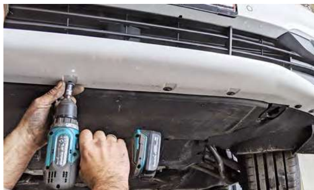
Bild 8: Nieten unterhalb der Stoßstange lösen
