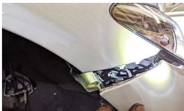
Bild 9: Stoßstange aus den Führungsschienen ausrasten
