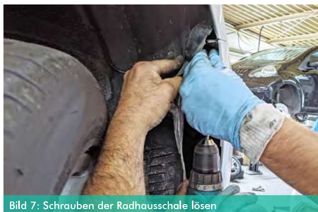
Bild 5: Schrauben der Radhausschale lösen
