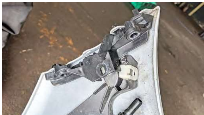
Bild 19: Zusätzliche Halter seitlich mit einschrauben
