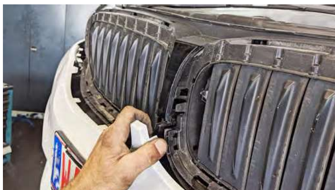
Bild 10: Stoßstange aus den Führungsschienen ausrasten
