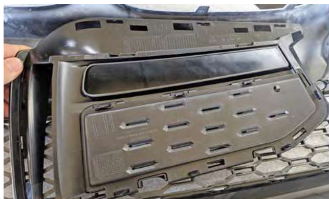
Bild 14: Stoßstangengitter + Abdeckung einrasten
