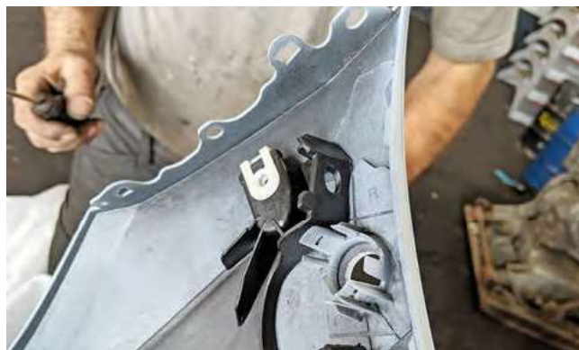
Bild 20: Zusätzliche Halter seitlich mit einschrauben
