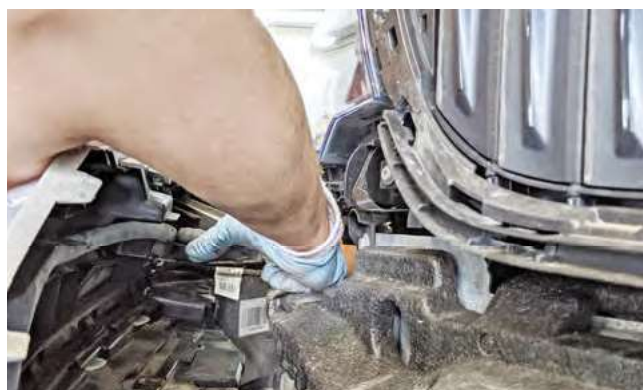
Bild 11: Stecker für PDC, Temperatur & SRA trennen
