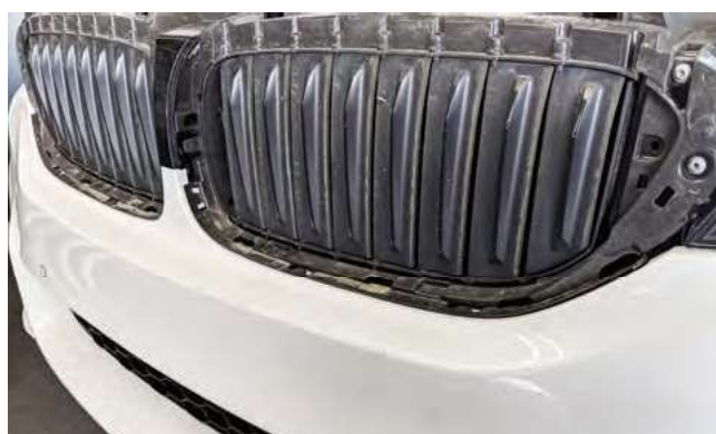
Bild 35: Stoßstange ausrichten und wieder zusammenbauen
