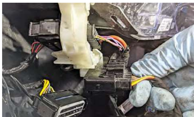
Bild 13: Stecker für PDC, Temperatur & SRA trennen
