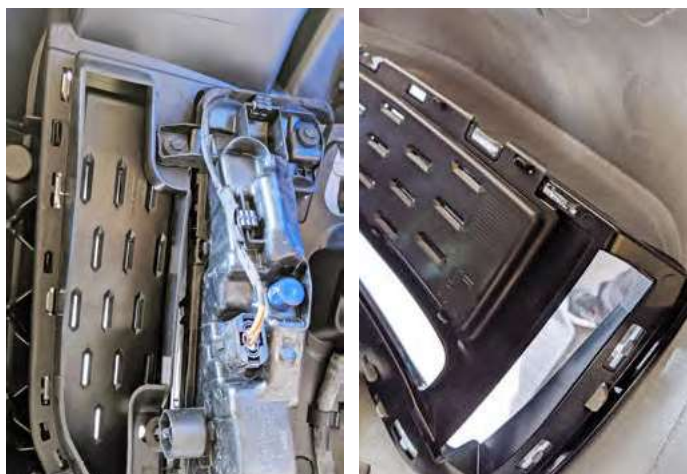
Bild 16+17: Stoßstangengitter + Abdeckung einrasten
