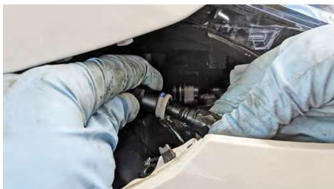
Bild 12: Stecker für PDC, Temperatur & SRA trennen
