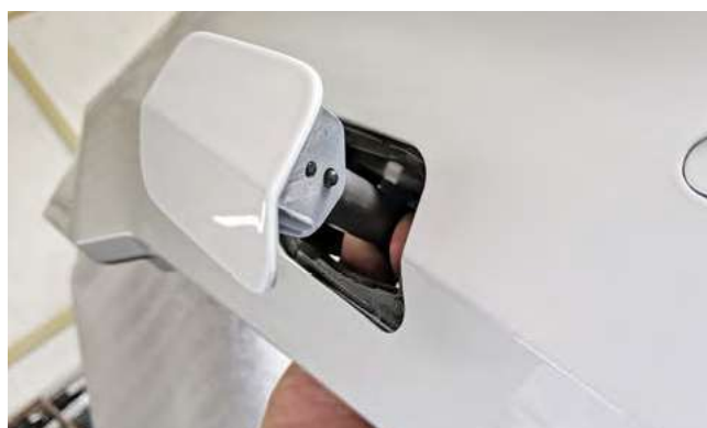
Bild 32: SRA-Abdeckungen in die Führungsschiene einrasten
