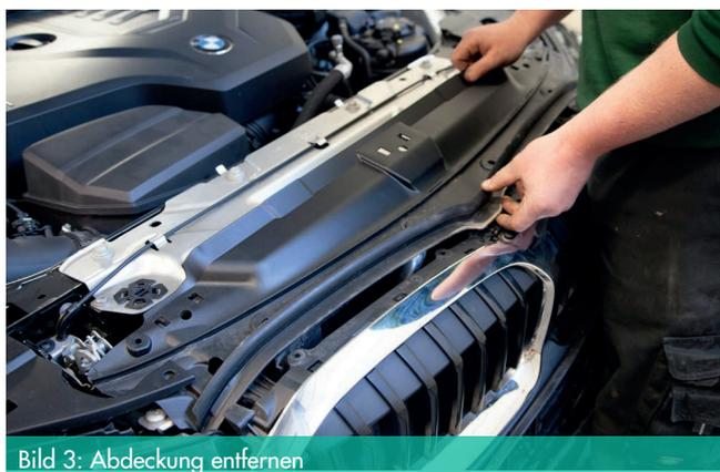
Bild 3: Abdeckung entfernen
