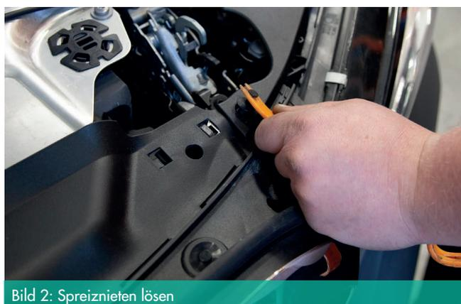
Bild 2: Spreiznieten lösen
