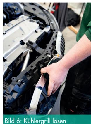
Bild 6: Kühlergrill lösen
