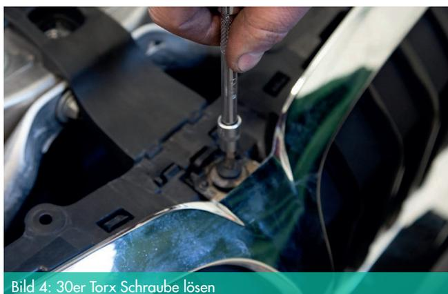
Bild 4: 30er Torx Schraube lösen
