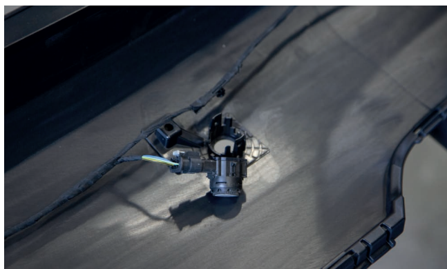
Bild 19: Original PDC Sensoren inkl. Kabelbau verbauen
