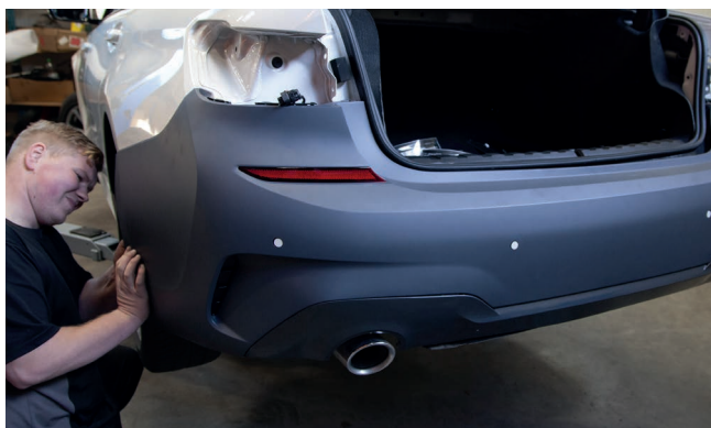
Bild 21: Stoßstange in Halterungsschiene einsetzen & ausrichten
