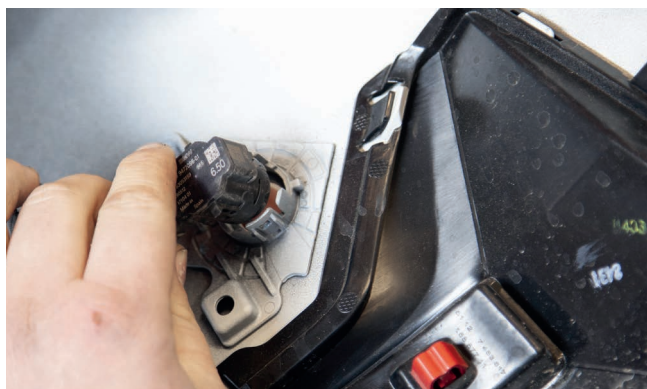
Bild 18: Original PDC Sensoren ausbauen
