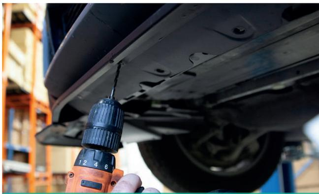
Bild 4: 4 Löcher vorbohren
