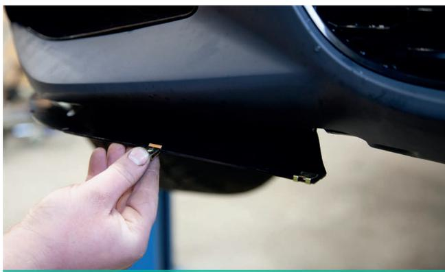
Bild 2: Schnappmuttern aufstecken
