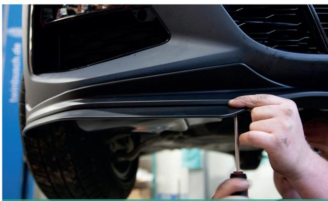
Bild 3: Frontspoiler inkl. Flaps montieren
