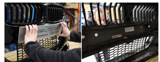
Wurde die optimale Position erreicht, fangen Sie an die restlichen Magnete einzukleben. Entfernen Sie die Klebeschutzfolien und führen Sie die Magnete knapp über der Oberfläche entlang. Findet der Magnet sein gegenüber, wird er angezogen und klebt sich fest an diese Position. Haben Sie die restlichen Magneten angeklebt entfernen Sie die beiden Magnete die zur Fixierung gedient haben und kleben diese auch fest.
